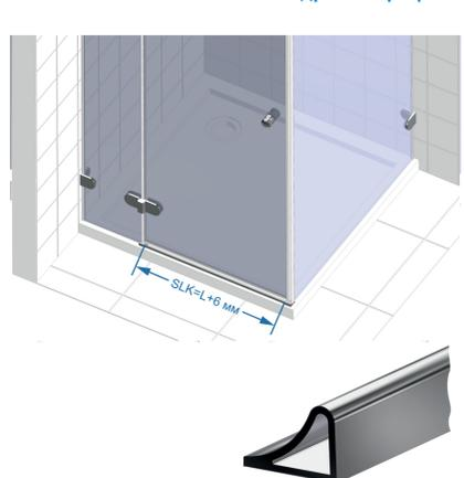
**Инструкция по монтажу водоотводного профиля PR-10-SLK**
